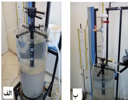
شکل ۷: کوبیدن مینی‌پیزومتر در مخزن متخلخل سامانه تبدالی رودخانه و آبخوان، و اندازه‌گیری گرادیان هیدرولیکی.
