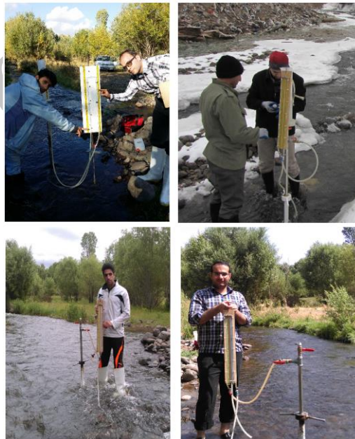
شکل ۹: برداشت شیب هیدرولیکی بین رودخانه آغمیون و آبخوان سراب طی چهار دوره نمونه‌برداری در طول مسیر رودخانه در بازه زمانی ۹۴/۷/۱۹ تا ۱۳۹۵/۴/۱۵.
