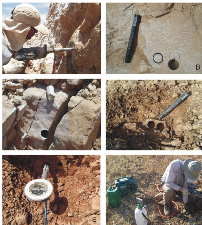
شکل ۶: عملیات نمونه برداری و مراحل استخراج نمونه (در منطقه مورد مطالعه) به منظور تجزیه و تحلیل مغناطیس دیرینه: (A) حفاری جهت استخراج نمونه، (B,C,D) نمونه‌های حفاری شده و علامت گذاری نمونه جهت برداشت درست موقعیت فضایی آن، (E) راستا نما که دارای قطب نمای مغناطیسی است و موقعیت محور نمونه حفاری شده را نشان می‌دهد، (F) برداشت موقعیت محور نمونه حفاری شده توسط راستا نما، ژنراتور تامین کننده نیروی دریل حفاری و پمپ آب خنک کننده مته.
