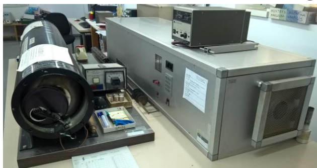
شکل ۸: مغناطیس‌زدا های حرارتی، انستیتو علوم زمین جائومه المرآ بارسلون اسپانیا (Institute Earth sciences Jaume Almera)
