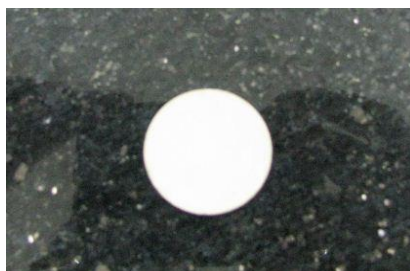
شکل ۱. سنگ کربناته برش داده شده برای آزمایش زاویه تماس
