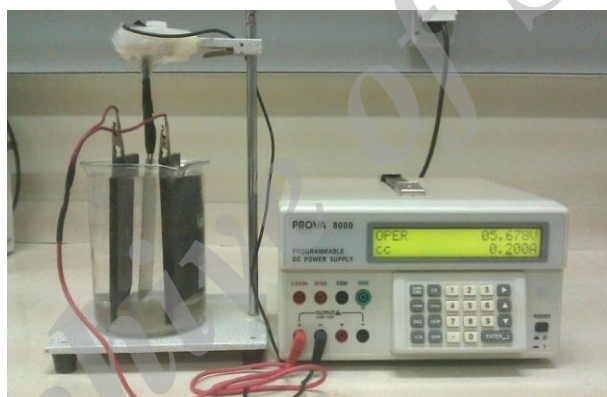
شکل ۱- سیستم آزمایشگاهی طراحی شده برای انجام آزمایشات ترسیب کاتدی
