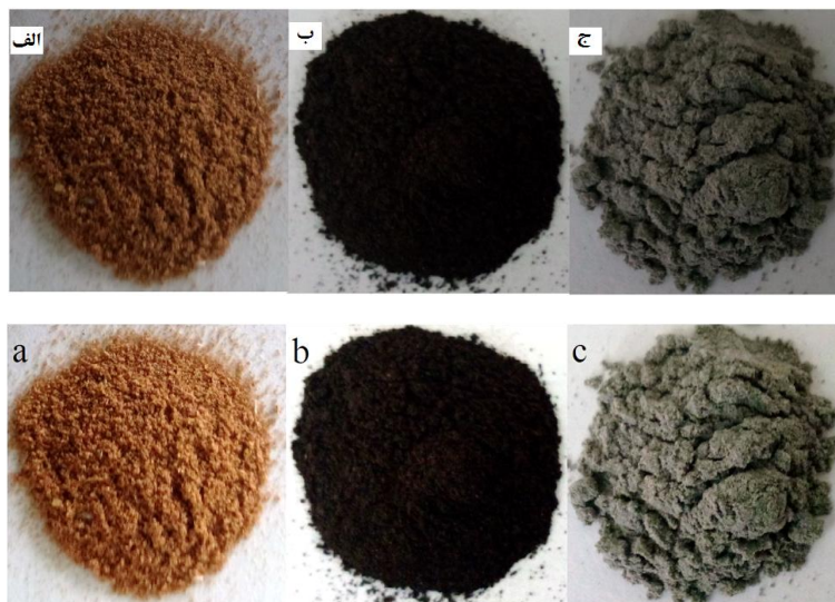
شکل ۱- مواد حاصل از برگ (a) پودر برگ خشک شده (b) ذغال پودر برگ و (c) خاکستر پودر برگ، که برای تهیه کامپوزیت با پلی‌وینیل‌پیرولیدون به کار رفتند.
