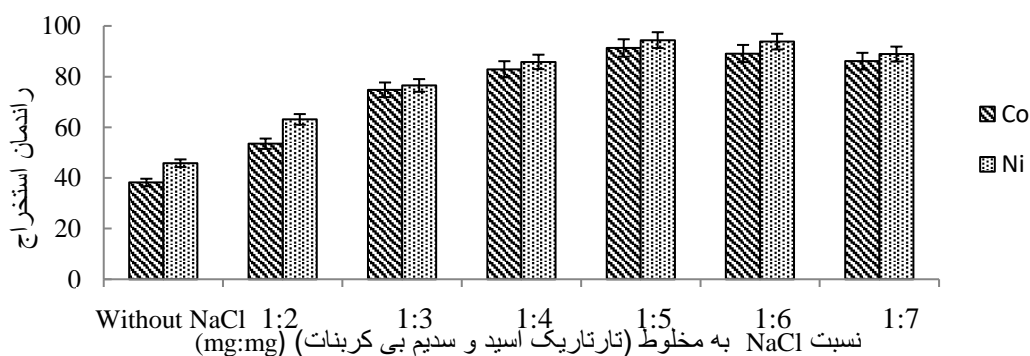
شکل ۵: بررسی تأثیر مقدار NaCl در قرص تهیه شده بر راندمان استخراج، شرایط استخراج مانند شکل ۴ می‌باشد با این تفاوت که وزن کلی قرصها ۶۰۰ میلی‌گرم می‌باشد.
