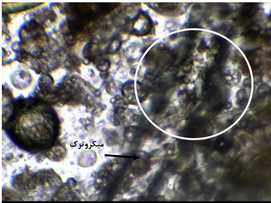
شکل ۶- تصاویر OM از فیلم در نقطه مورد نظر بلافاصله بعد از تشکیل ترک
