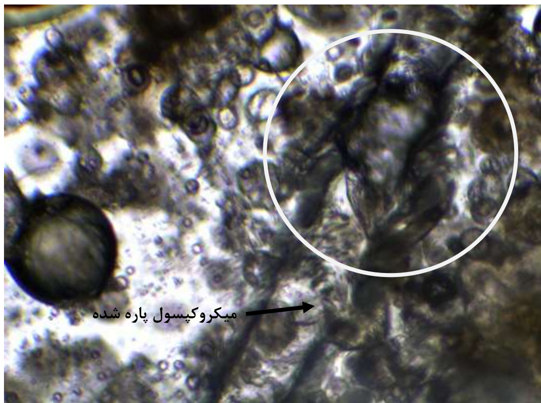
شکل ۷- تصاویر OM از فیلم در نقطه مورد نظر یک ساعت بعد از تشکیل ترک
