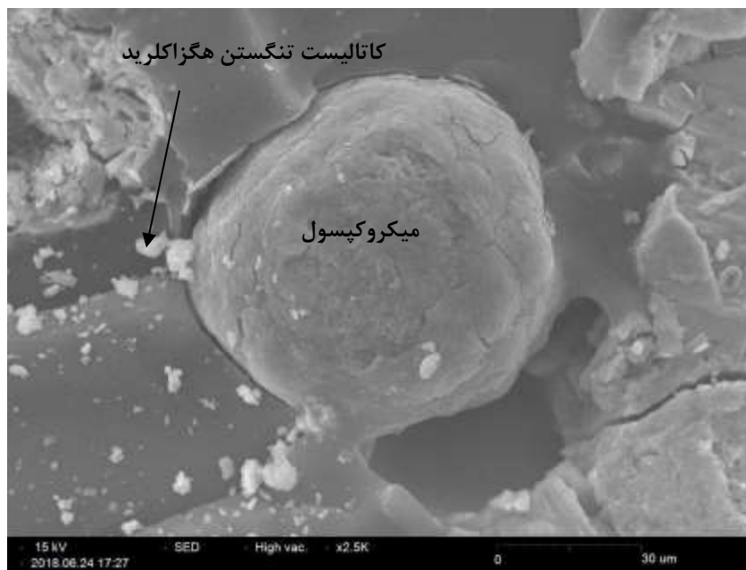
شکل ۵- میکروکپسول جاسازی شده در ماتریس اپوکسی
