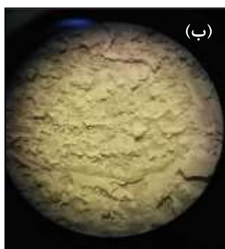
شکل ۱. الف) نمودار جریان / زمان (ب) تصویر میکروسکوپ نوری سوختگی نمونه حاصل از فرآیند آندی کردن آلومینیوم تحت ولتاژ ثابت ۱۷۶ ولت در دمای ۲۰°C در اسید فسفریک ۰/۳ مولار.
