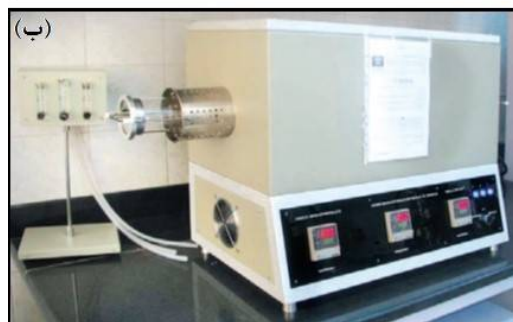
شکل ۲. الف: طرحواره‌ای از فرآیند سولفوردهی و ب: تصویر کوره استفاده شده در آزمایشگاه نانوفیزیک دانشگاه دامغان.
