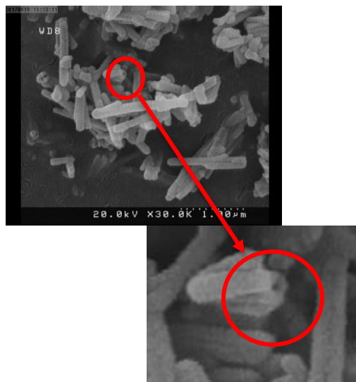
شکل ۶. تصویر FESEM نانولوله ZnS
