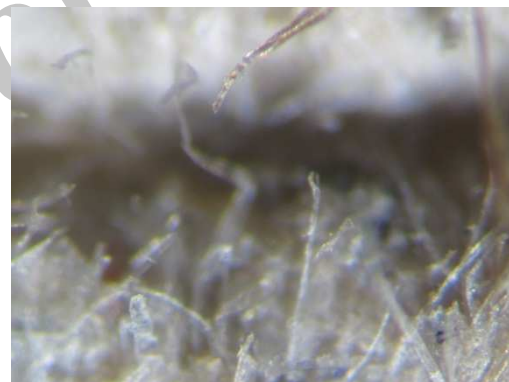
شکل ۶: تصویرخلل و فرج صافی کاغذی که توسط میکروسکوپ انعکاسی ۱۲۰ برابر شده است.
