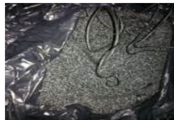
شکل (5): نمایی از گرانول به‌دست آمده از دستگاه خردکننده پلیمر.
