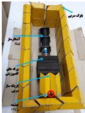
شکل (11): چیدمان آزمون هسته‌ای برای تعیین میزان تضعیف پرتوهای گامای 137 Cs.
