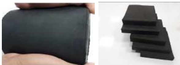
(6): نمایی از حفاظ انعطاف‌پذیر ساخته شده.
