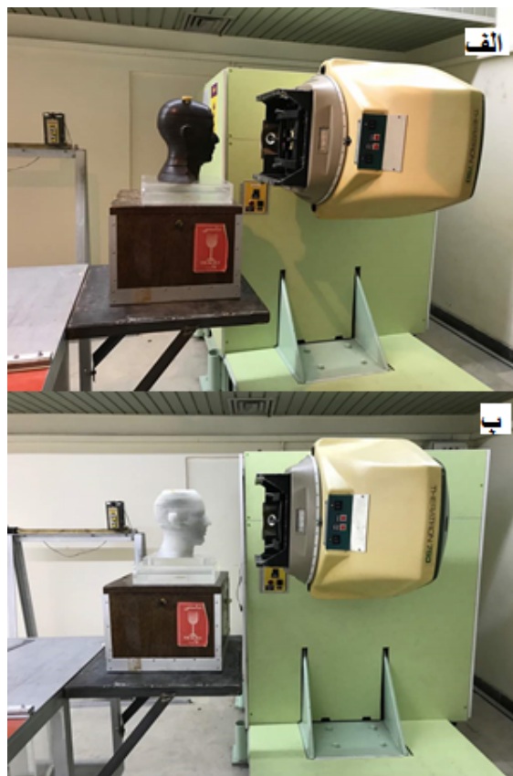
شکل (4): نمایی از پرتو دهی هر دو فانتوم در میدان یکسان گامای چشمه کبالت-60.
