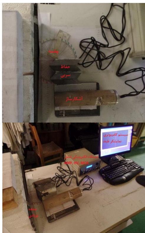
شکل (۱): چگونگی قرارگیری تجهیزات ضخامت سنج صفحه فولادی.
