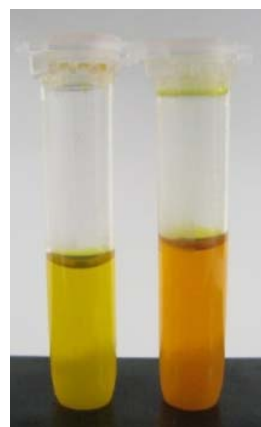
شکل ۳- سنجش فعالیت آنزیمی کیتیناز به‌وسیله رنگ‌سنجی با DNS سمت چپ، شاهد و سمت راست، نمونه حاوی آنزیم کیتیناز
