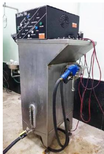
شکل ۱- دستگاه تصفیه روغن پسماند.
