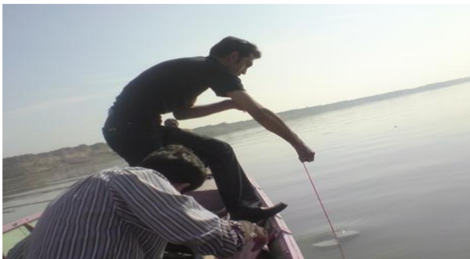
شکل ۲. سچی دیسک معلق در آب به منظور اندازه‌گیری شفافیت آب- مقطع کارون در اهواز
