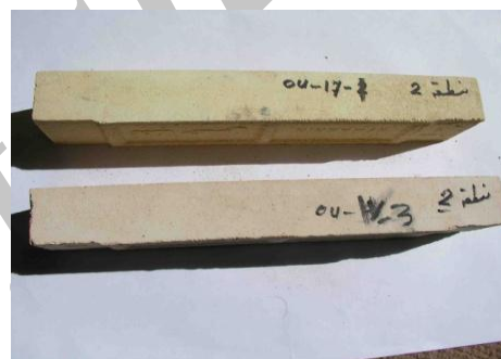
شکل ۱۶. پخت آجر از خاک رس اندیس شمالشرق اصفهان
