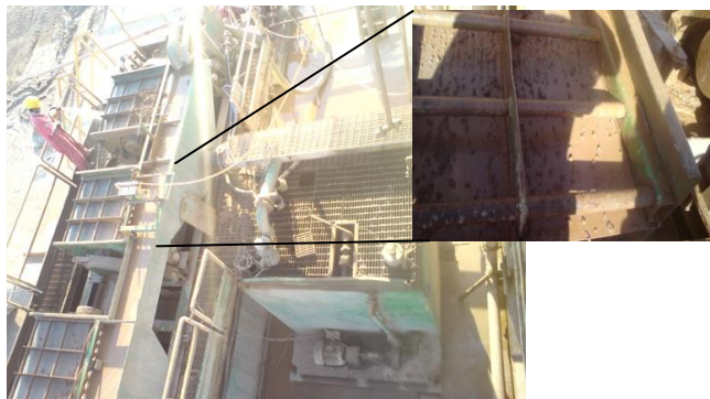
شکل ۲. نمایی از الکهای لرزان و خرده‌های خارج شده از چاه حفاری
