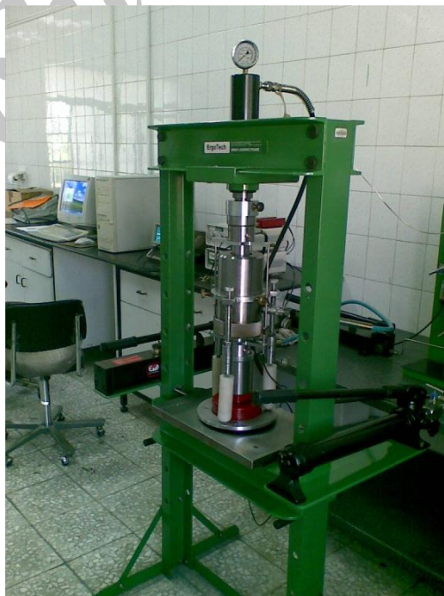
شکل ۳. دستگاه آزمایش تراسونیک تحت فشار
