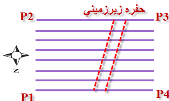
شکل ۳. نمایی از موضع گیری شرقی - غربی پروفیل ها در محدوده مورد مطالعه. مختصات چهار گوشه شبکه مستطیلی در جدول (۱) ارائه شده است.
