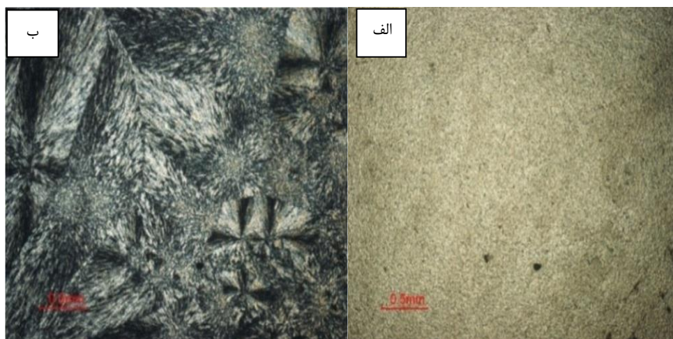
شکل ۳. بافت اسفرولیتی (به سمت مرکز موزاییک های اسفرولیتی بزرگتر می شوند) در الف (نور PPL) و ب (نور XPL)
