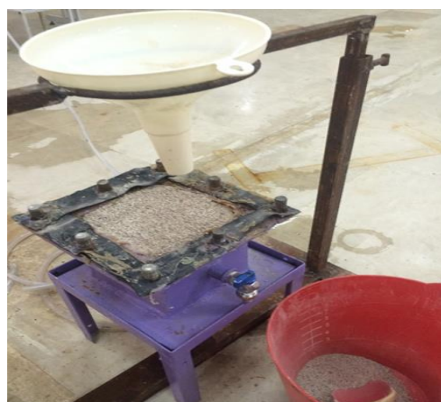
شکل ۶. آماده سازی نمونه به روش ریزشی
