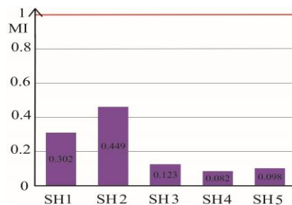
شکل ۹- مقدار شاخص فلزی محاسبه شده برای نمونه‌های مورد بررسی (خط قرمز بیانگر حد مجاز).
