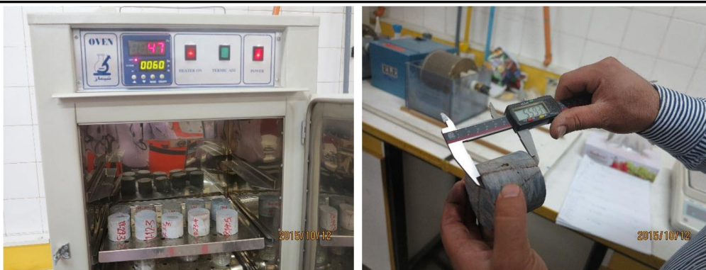
شکل ۸- اندازه‌گیری چگالی نمونه‌های منظم.
