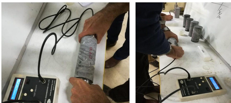
شکل ۷- اندازه‌گیری سرعت موج فشاری نمونه‌های سنگ شیست.
