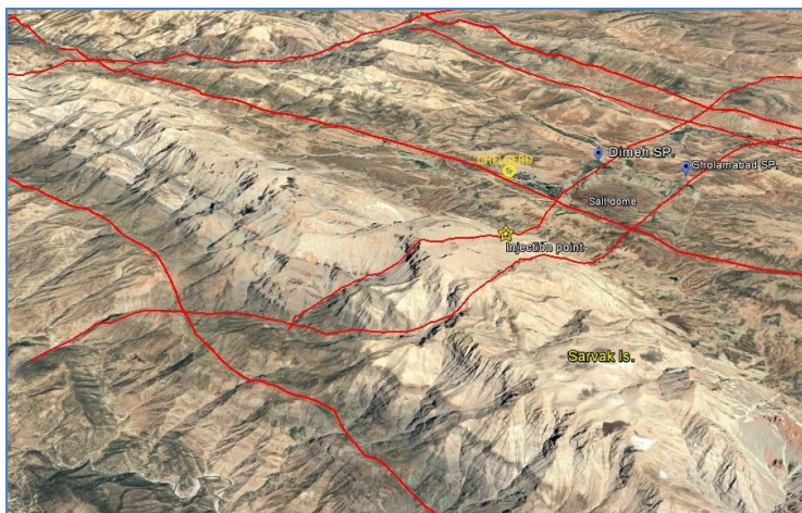
شکل ۳- نمایی از محل تزریق و ارتباط آن با گسل‌های عرضی موجود در منطقه.
