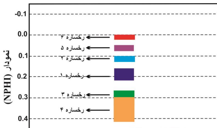
شکل ۱۱- میزان فراوانی تخلخل نوترونی (NPFI) در رخساره‌های الکتریکی از رخساره شماره ۱ به سمت رخساره شماره ۶ ناحیه مورد مطالعه.
