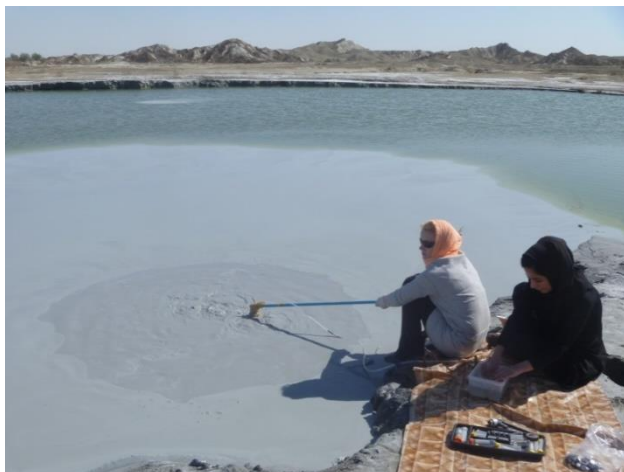
شکل ۶: روش نمونه برداری از گاز در گل فشان‌های مورد مطالعه.
