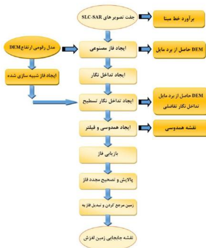
شکل ۳. نمودار گردش پردازش به روش تداخلسنجی تفاضلی دو عبوره برای تصاویر ASAR
