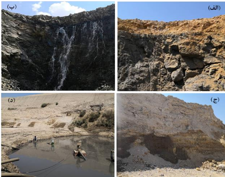
شکل ۲. مرز بین لایه متراکم ابرفتی و سازند سخت (الف)؛ خروج آب از دیواره‌های پیت (ب) و (ج)؛ حوضچه موجود در پله دهم جهت پمپاژ آب زهکشی شده از پیت (د)
