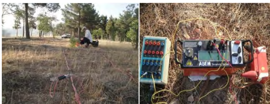
شکل ۷. نمایی از دستگاه مورد استفاده و پروفیل برداشت مقاومت ویژه الکتریکی زمین به روش آرایه قطبی-دوقطبی (Easting: 517652.36 / Northing: 3955028.56).
