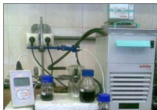
شکل ۹: تصویر دستگاه آزمایشگاهی مورد استفاده در اندازه گیری ضریب هدایت حرارتی نانوسیالات
