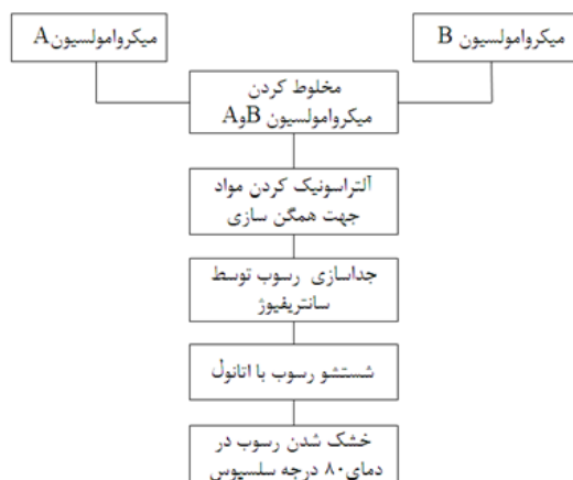
شکل ۱ مسیر انجام سنتز نانو پودرهای گارنت ایتريوم آهن به روش میکروامولسیون
