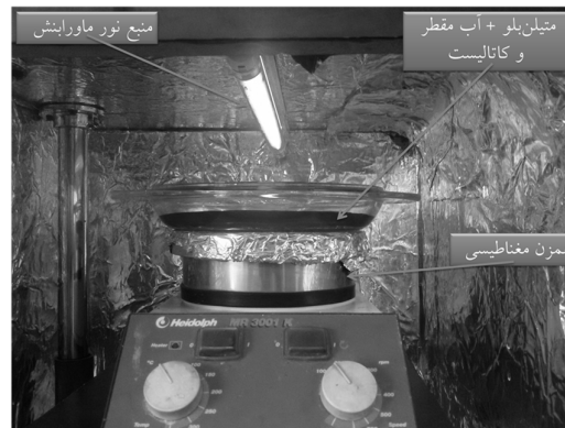
شکل ۱: تصویر فوتوراکتور استفاده شده برای تخریب متیلن‌بلو در حضور کاتالیست SrFe 12 O 19
