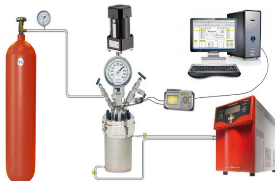
شکل ۵: سیستم آزمایشگاهی مطالعه فرایند تشکیل هیدرات گازی
