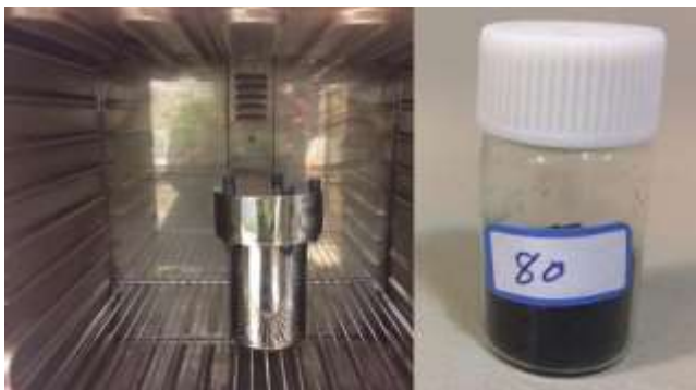
شکل ۱: اتوکلاو و نانو کامپوزیت N-GO سنتز شده به روش هیدروترمال.
