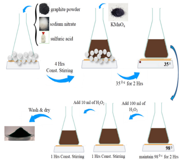
شکل ۱: طرح‌واره‌ای از ساخت گرافن اکسید.
