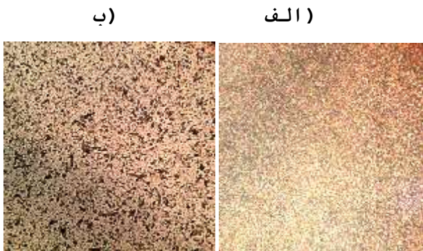
شکل ۱: تصویر میکروسکوپی نمونه‌ها با لایه نشانی در: (الف) دمای ثابت (ب) دمای متغیر
