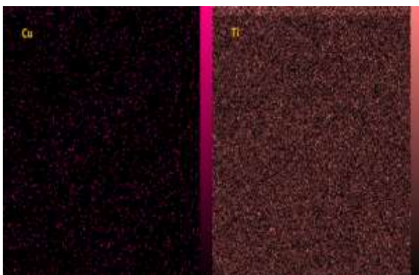
شکل ۷ تصویر EDX-Map مربوط به مس (چپ) و تیتانیوم (راست)
