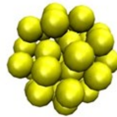
شکل ۲: نانوذره طلا با قطر ۱۰ آنگستروم
