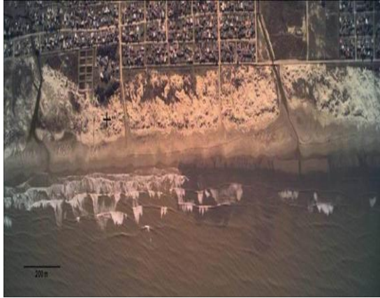
شکل ۱. تفاوت دامنه امواج در قسمتی از دریا که جنس بستر از نوع گل ولایی است (ناحیه تیره) با دیگر نواحی در خلیج مکزیک
