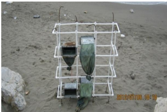
شکل ۳. تله‌گیر رسوب مورد استفاده در تعیین نرخ انتقال رسوب در ساحل شهر نور
