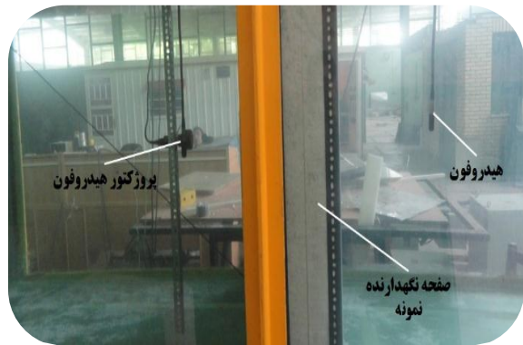
شکل ۳: چیدمان اندازه‌گیری در حوضچه
