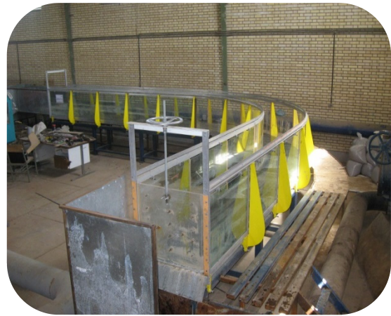
شکل ۱. فلوم قوسی مورد استفاده برای مدل سازی ها، دانشگاه شهید چمران اهواز
