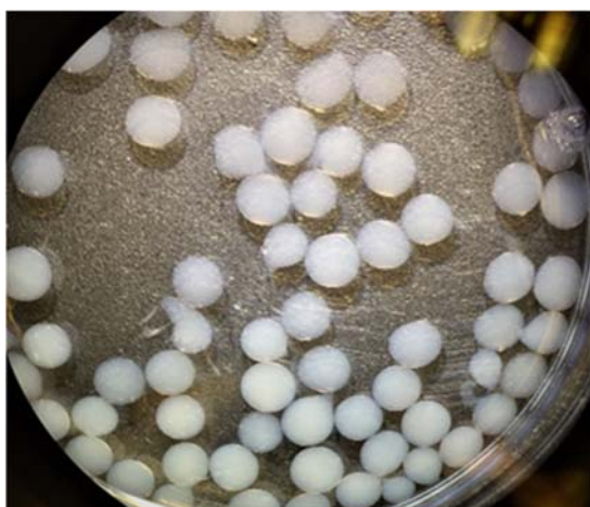
شکل ۶ دانه های هیدروژل- نقاط کوانتومی کربنی
