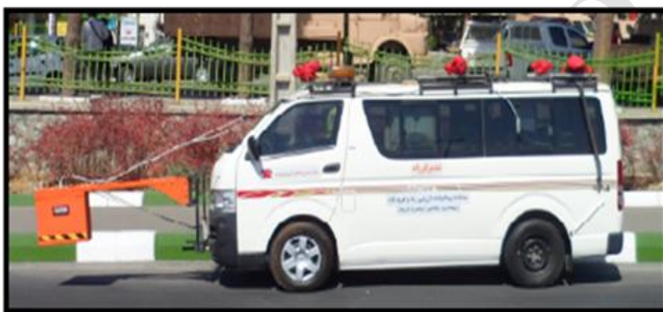
شکل ۳: یک سیستم GPR پیمایش جاده‌ای با آنتن نوع هورن دو گیگا هرتز پوششی ساخت شرکت GSSI.
