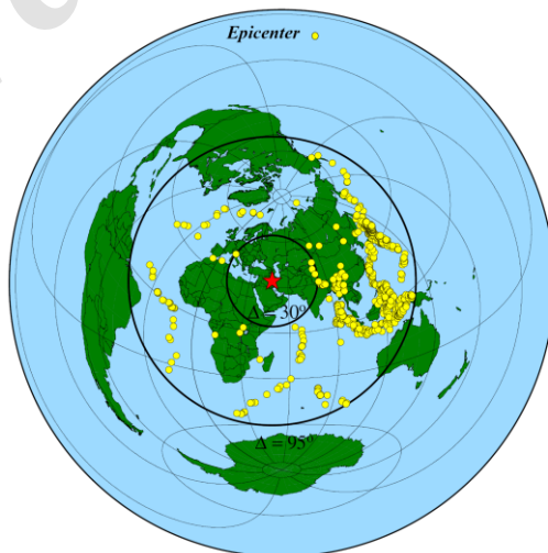
شکل ۳: توزیع رومرکز زمین‌لرزه‌های دور لرزه استفاده شده برای محاسبه توابع گیرنده P. دایره‌های زرد نماینده رومرکز زمین‌لرزه‌های دور لرزه و مثلث قرمز رنگ مرکز منطقه‌ی کرمانشاه و خرم‌آباد است. دو دایره سیاه رنگ در فواصل 30^\circ و 95^\circ فواصل رومرکزی را از مرکز مشخص می‌کنند.
