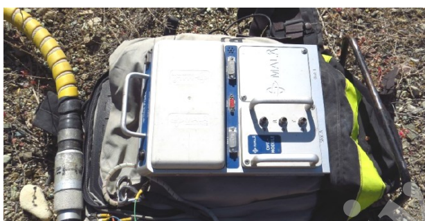
شکل ۸: دستگاه GPR مالا (MALA) مورد استفاده برای برداشت تونل شماره ۳ آزادراه تهران - پردیس.
