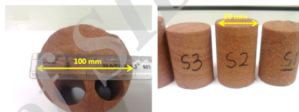
شکل ۱: نمونه‌های استوانه‌ای آبخوان ماسه‌سنگی با قطر ۲۰ میلی‌متر و طول حدود ۴۰ میلی‌متر که از مغزه‌ی ماسه‌سنگی با قطر ۱۰۰ میلی‌متر استخراج شده‌اند.
