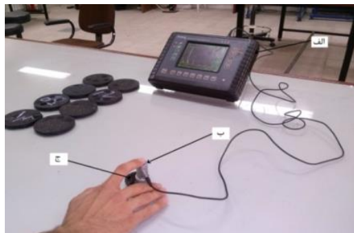
شکل ۳ سامانه اندازه‌گیری سرعت امواج فراآوایی: الف) دستگاه فراآوایی، ب) تراگذار و ج) نمونه آمیزه لاستیکی.
